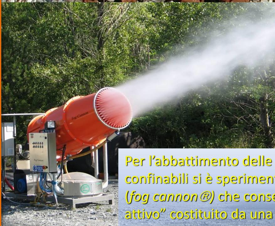
Per l'abbattimento delle polveri in condizioni di lavoro non confinabili si è sperimentato l'impiego di un cannone nebulizzatore (*fog cannon*®) che consente di creare un efficace "confinamento attivo" costituito da una nube di acqua micronizzata.
